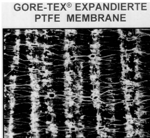
Abb. 2. Elektronenmikroskopische Aufnahme einer PTFE-Membran.
