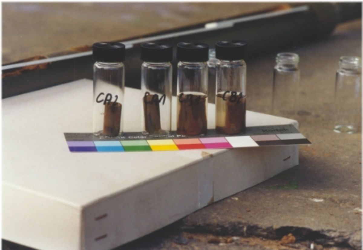
Bild 3: Probengläschen beschickt mit Probenkernen links: 2 x trocken rechts: 2 x in METHANOL
