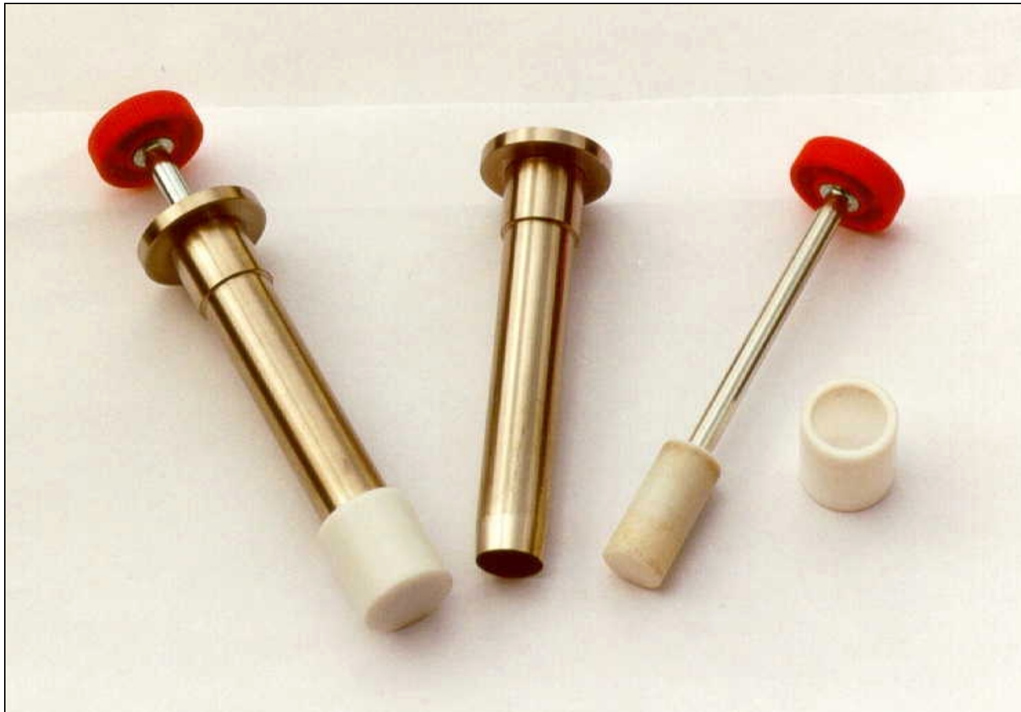
Bild 1 : metallischer Probenstecher mit Ausstoßzylinder ( INST. BERGHOF, Tübingen )
