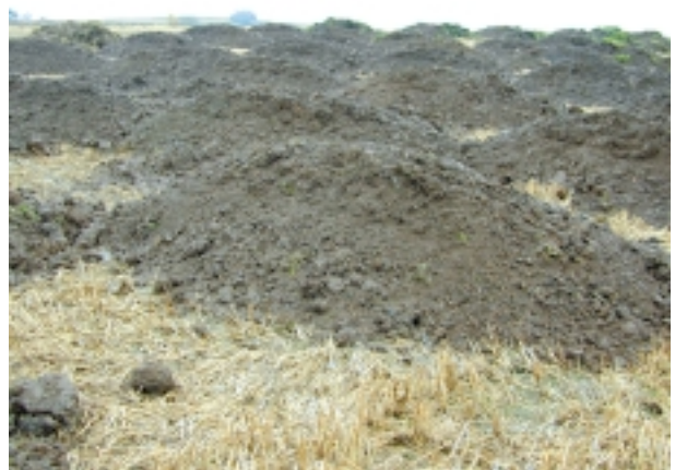
Abb. 1 und 2. Häufig anzutreffende heterogene Materialaufschüttungen mit den entsprechenden Problemen einer repräsentativen Beprobung gemäß den Vorgaben der BBodSchV.
