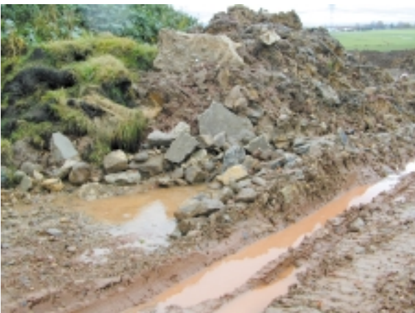
Abb. 1 und 2. Häufig anzutreffende heterogene Materialaufschüttungen mit den entsprechenden Problemen einer repräsentativen Beprobung gemäß den Vorgaben der BBodSchV.
