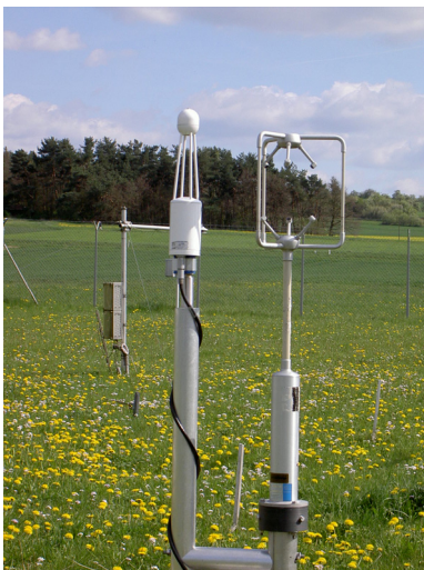
Messsystem zur Bestimmung des \text{CO}_2 -Austausches zwischen dem Lindener Dauergrünland und der bodennahen Atmosphäre
